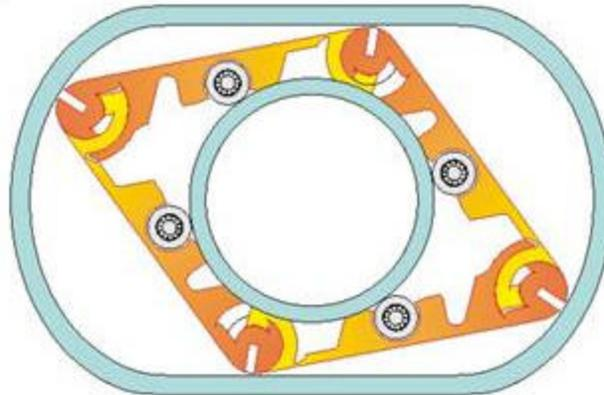
La Quasiturbine à excentricité losange élevée (ici 0.578 pour le modèle QTSC - Sans Chariot) peut ne pas être le cas le plus pratique (l'angle de l'arête variant de 90 - 30 à 90 + 30 degrés), mais elle met en relief le « profil patinoire Saint-Hilaire de confinement ».
